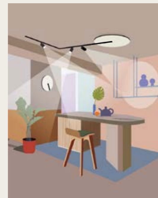
Accensione separata di proiettori 48V su binario con giunto L, con plafoniera Sol Maior spenta.
